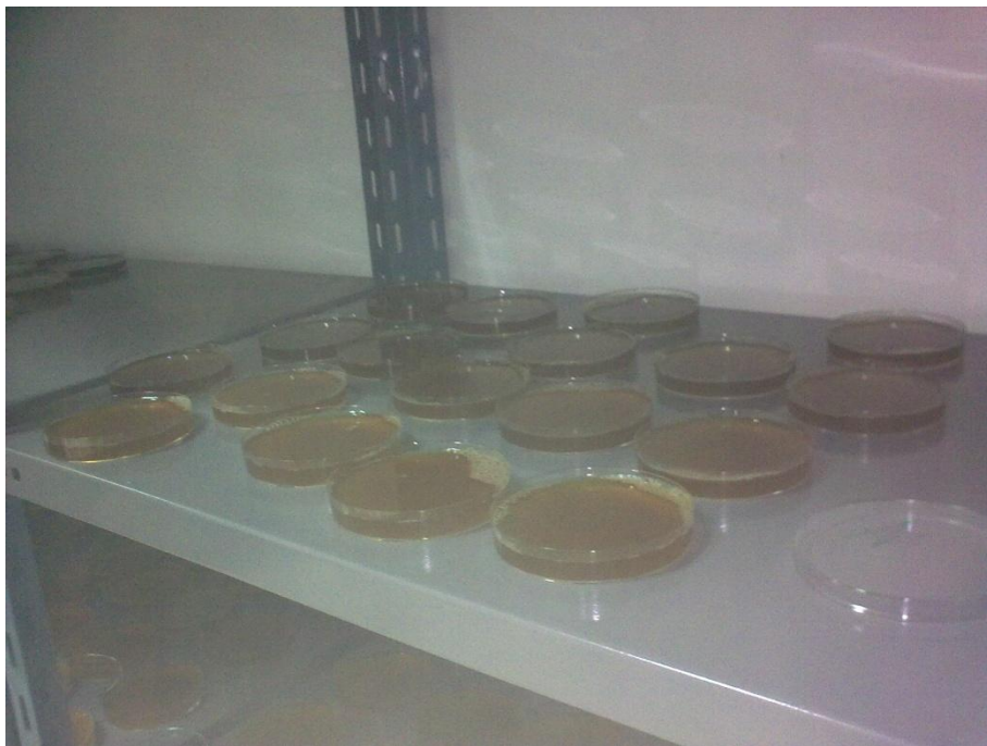
ภาพที่ 4.1 แสดงการผลิตแบคทีเรียเซลลูโลสในงานเพาะเชื้อ
