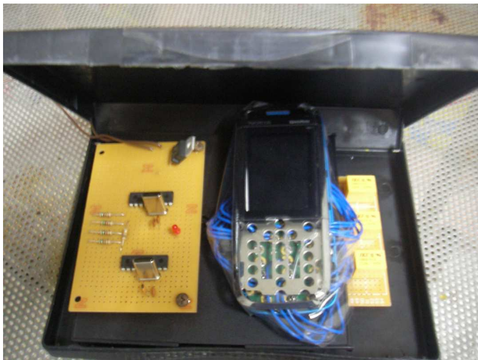
ภาพที่ 4.1 นวัตกรรมเครื่องเตือนภัยโจรกรรมรถยนต์ที่ใช้สมองกลฝังตัวควบคุมการส่งคลิปวีดิโอทางโทรศัพท์เคลื่อนที่ระบบจีเอสเอ็ม
