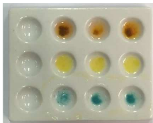
ภาพที่ 4.3 ตัวอย่างทดลองอัลปราโซแลมหลังหยดน้ำยาเคมีทดสอบผ่านไป 10 นาที
