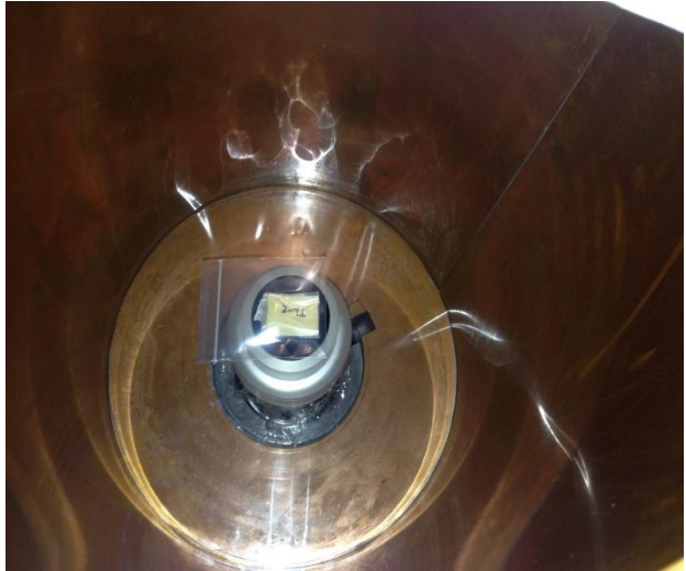
รูป 4 แสดงหัววัดรังสี และการเข้าเครื่องวัดรังสี
