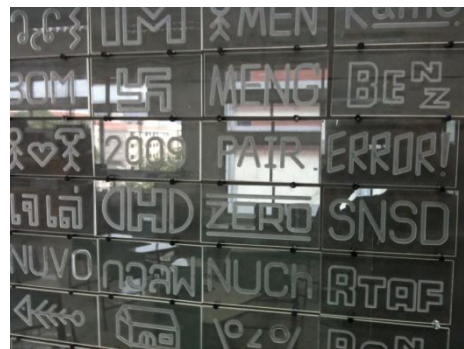
รูปที่ 2 ปฏิบัติการสร้างชิ้นงานด้วยเครื่องกัดซีเอ็นซีชนิด 3 แกน
